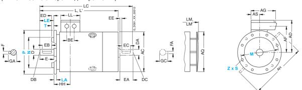
Двигатели поставляются с двумя установленными рым-болтами в соответствии с типом монтажного исполнения IM В5 благодаря чему имеется возможность изменения позиции в соответствии с типом монтажного исполнения IM V1 или IM V3. Необходимо отметить, что не следует прикладывать усилие перпендикулярно плоскости кольца.
