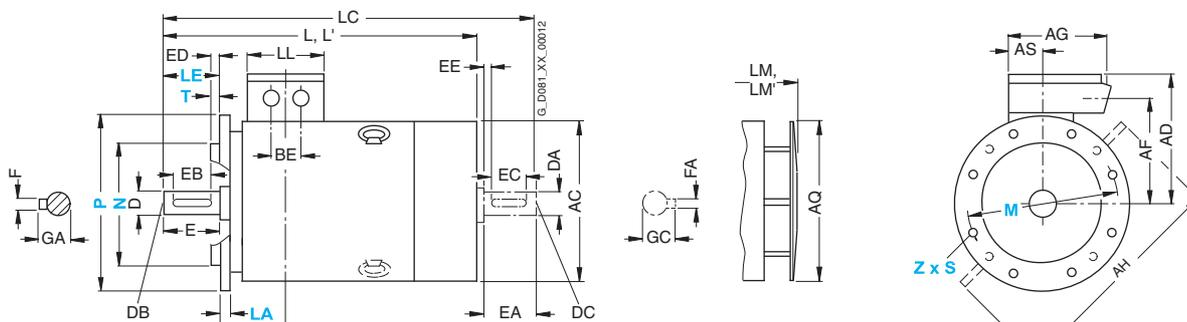
Двигатели поставляются с двумя установленными рым-болтами в соответствии с типом монтажного исполнения IM B5, благодаря чему имеется возможность изменения позиции в соответствии с типом монтажного исполнения IM V1 или IM V3. Необходимо отметить, что не следует прикладывать усилие перпендикулярно плоскости кольца.
