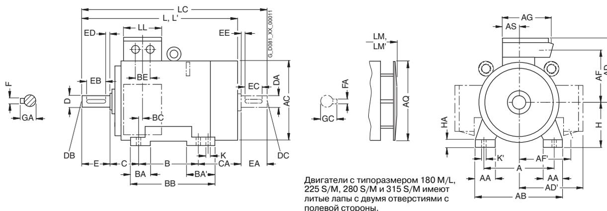
Двигатели с типоразмером 180 М/Л, 225 S/М, 280 S/М и 315 S/М имеют литые лапы с двумя отверстиями с полевой стороны.
